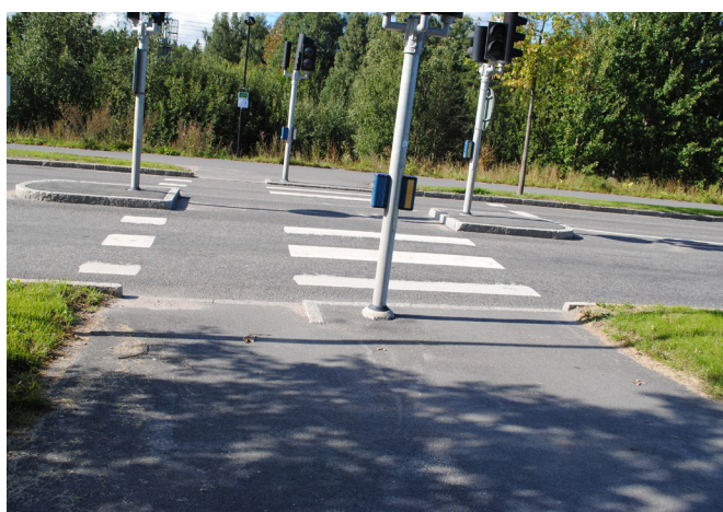
چراغ راهنمایی و محل عبور عابر پیاده از عرض خیابان - در این محل جدول کنار خیابان با کف خیابان هم سطح شده تا عبور عابر پیاده، معلولین و کالسکه کودکان را تسهیل سازد.
