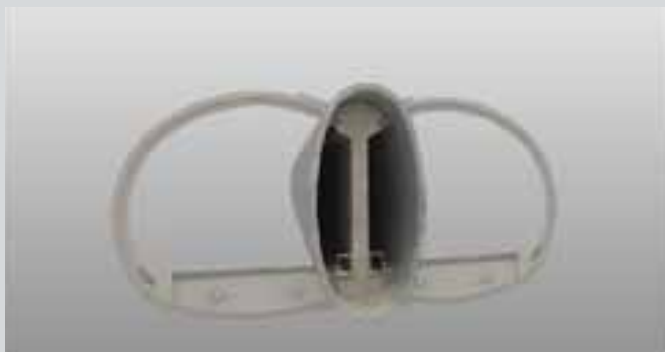
شکل ۱۴- وضعیت تونل بعد از حفاری گالری و اجرای دیوار میانی
