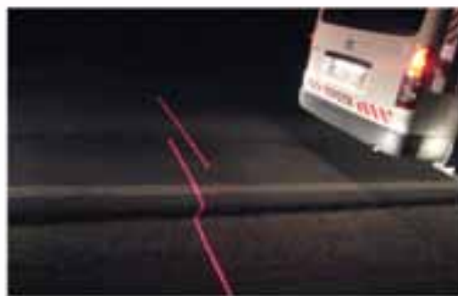
برداشت پروفیل عرضی ناهمواری بوسیله لیزرهای مستقر در عقب دستگاه
